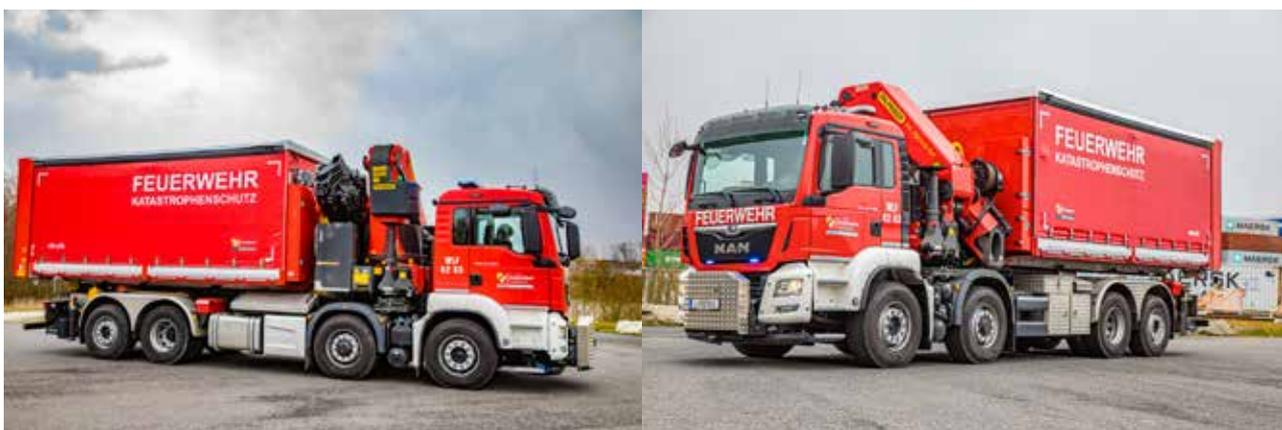
Kranfahrzeug wird dieser Fahrzeugtyp eine deutliche Steigerung der Flexibilität mit sich bringen, da durch unterschiedliche Mulden unterschiedliche Einsatzszenarien bedient werden können. Ein deutlich größeres Fahrgestell **samt Hakenlift**, ein **massiv stärkerer und größerer Kran** (mindestens 72-Meter-Tonnen) sowie eine komplett neue Steuerung bedeuten jedoch auch einen großen Schulungsaufwand, den wir neben den anderen Projekten gemeinsam meistern werden.
