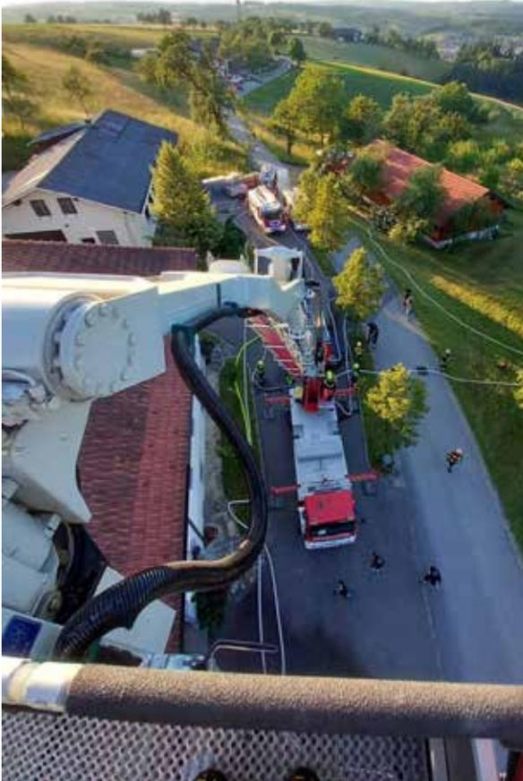
Der Wasserwerfer der Teleskopmastbühne erlaubt ordentliches Löschen von oben - sofern das Löschwasser ausreichend zur Verfügung steht.
